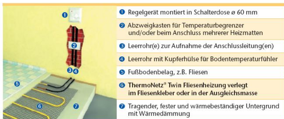
Regelgerät montiert in Schalterdose, Abzweigkasten für Temperaturbegrenzer und/oder beim Anschluss mehrerer Heizmatten
