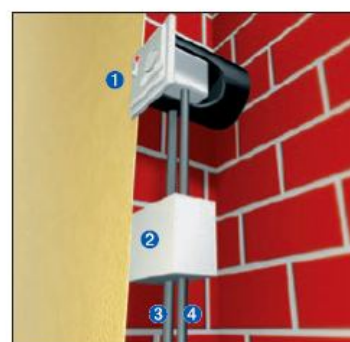
Regelgerät montiert in Schalterdose, Abzweigkasten für Temperaturbegrenzer und/oder beim Anschluss mehrerer Heizmatten
