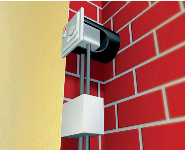
Schematische Darstellung eines Unterputz-Temperaturreglers
